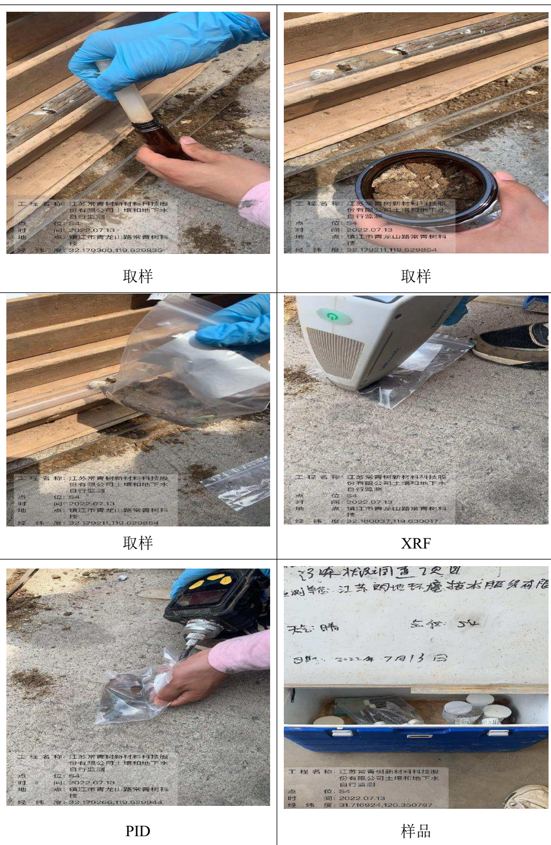
图 6.2-1 钻井取土采样
