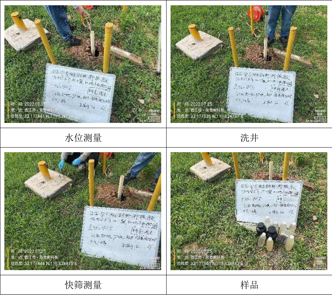
图 8.2-2 地下水建井至采样流程照片
