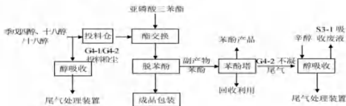
图 4.1-5 亚磷酸季戊四醇双十八酯/亚磷酸三-（十八）酯工艺流程图
